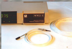
Монитор мощности дозы гамма- и нейтронного излучений с герметичным тканевкивалентным алмазным детектором
