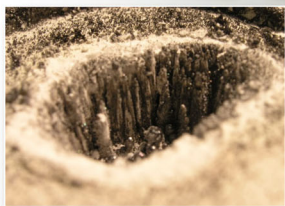
Общий вид мишени из BN после воздействия излучением лазера.
