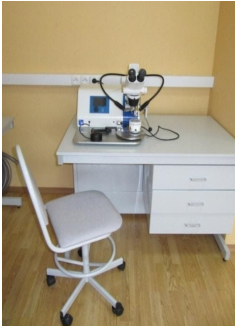
Рис. 5. Установка микросварки проволокой и лентой NB04.
