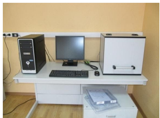
Рис. 7. Сканирующий нанотвердомер «НаноСкан-Компакт».
