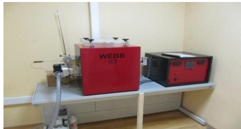
Рис. 1. Высокотемпературная вакуумная печь RD-G WEBB-117.
