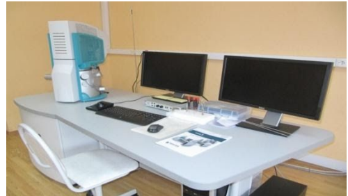
Рис. 6. Сканирующий электронный микроскоп TESCAN VEGA3 LMH.
