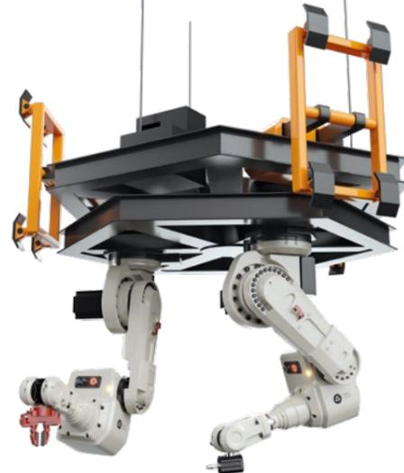
При демонтаже корпуса реактора планируется создать дистанционно-управляемую систему (ДУС), включающую в себя робота-манипулятора с функцией захвата объектов и подвижной выносной оптический модуль (ВОМ), непосредственно для фрагментации объекта демонтажа.
