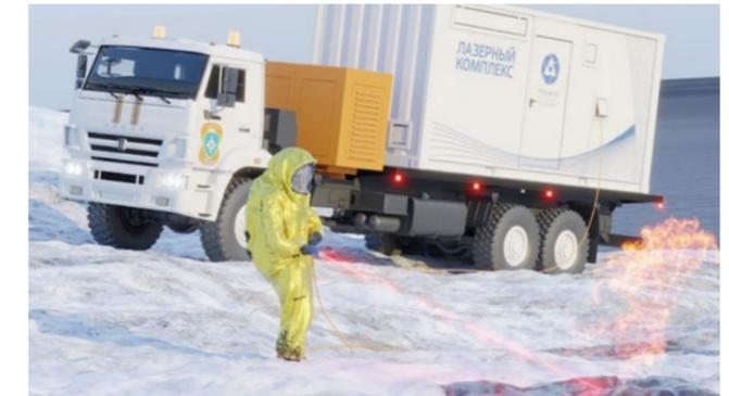
Ликвидация последствий разлива нефтепродуктов в прибрежной зоне с использованием транспортного оптоволоконна
