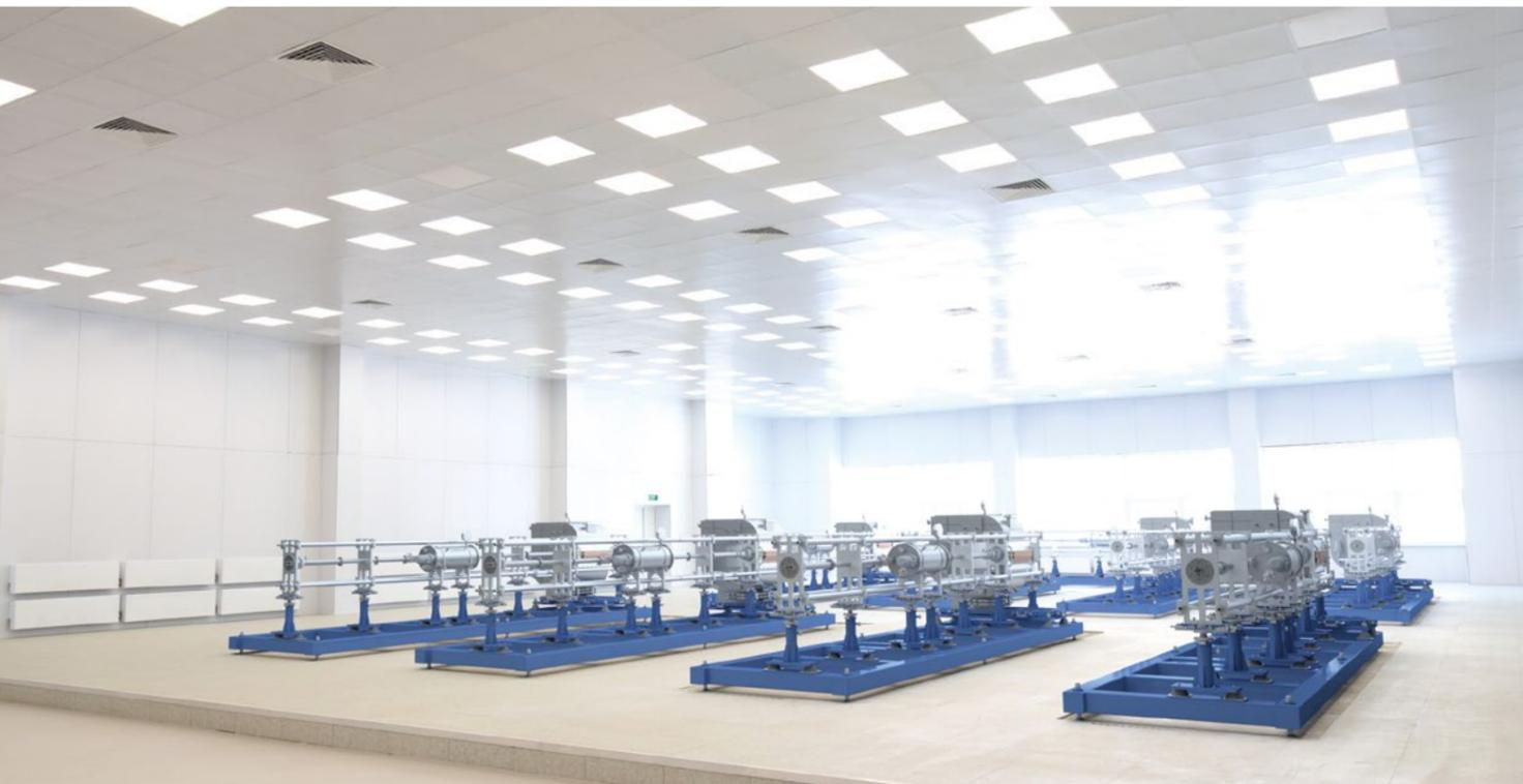
В АО «ГНЦ РФ ТРИНИТИ» разработана технология лазерного разделения изотопов углерода. Данный метод не имеет мировых аналогов и позволяет получать высокообогащенный изотоп  $^{13}\text{C}$ , нашедший широкое применение в медицине.
