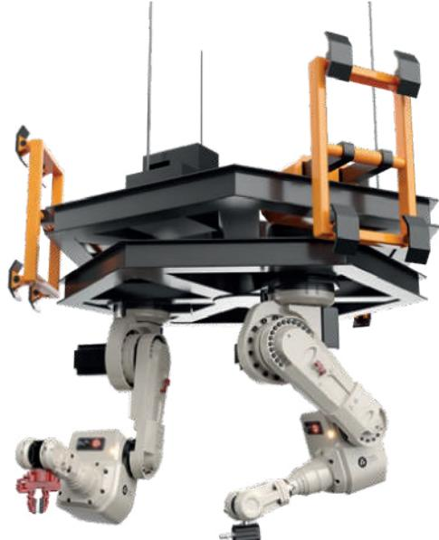
При демонтаже корпуса реактора планируется создать дистанционно-управляемую систему (ДУС), включающую в себя робота-манипулятора с функцией захвата объектов и подвижный герметичный выносной оптический модуль (ВОМ), непосредственно для фрагментации объекта демонтажа.
