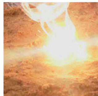
Лазерный поджиг и самоподдерживающееся горение на различных поверхностях: на льду, на воде под снегом, на открытой воде и на песке
