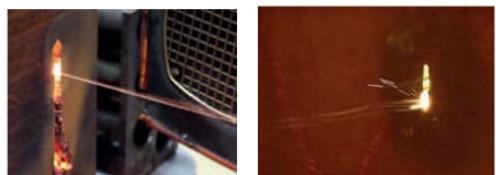
Резка толстостенного металла, имитирующего корпус атомного реактора
