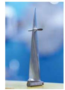
Примеры деталей, обработанных импульсным потоком плазмы
