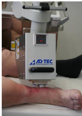
Рис.1. Медицинский прибор на MW плазме the Max Planck Institute for Extraterrestrial Physics (Germany). Прибор с использованием 6 электродов выдает холодный плазменный факел. Газ: аргон; Частота = 2,3 ГГц; Мощность = 100 W.
