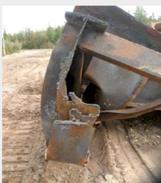
Примеры лазерной резки конструкций объектов, разрушенных при аварии на газовой скважине.
