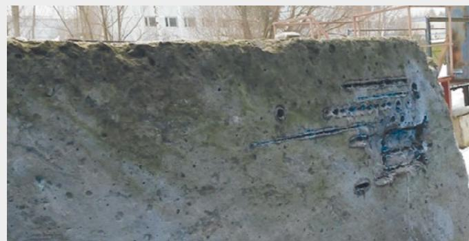
Тестовый бетонный блок 780x660x510 мм
