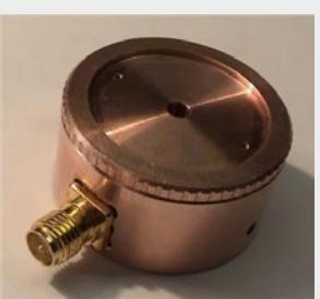
Корпус детектора с разъемом для подключения
