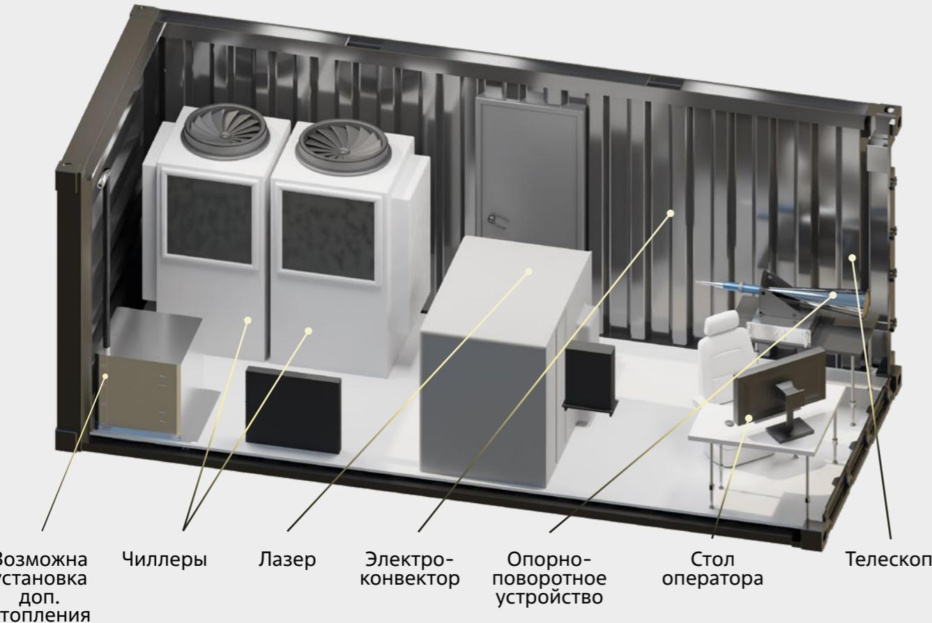
**В АО «ГНЦ РФ ТРИНИТИ» на основе серийного иттербийевого лазера спроектирован мобильный лазерный технологический комплекс, который предназначен для выполнения таких видов работ, как:**
