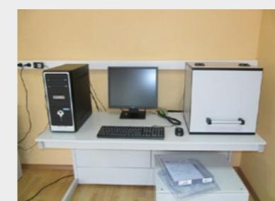
Сканирующий нанотвердомер "НаноСкан - Компакт"
