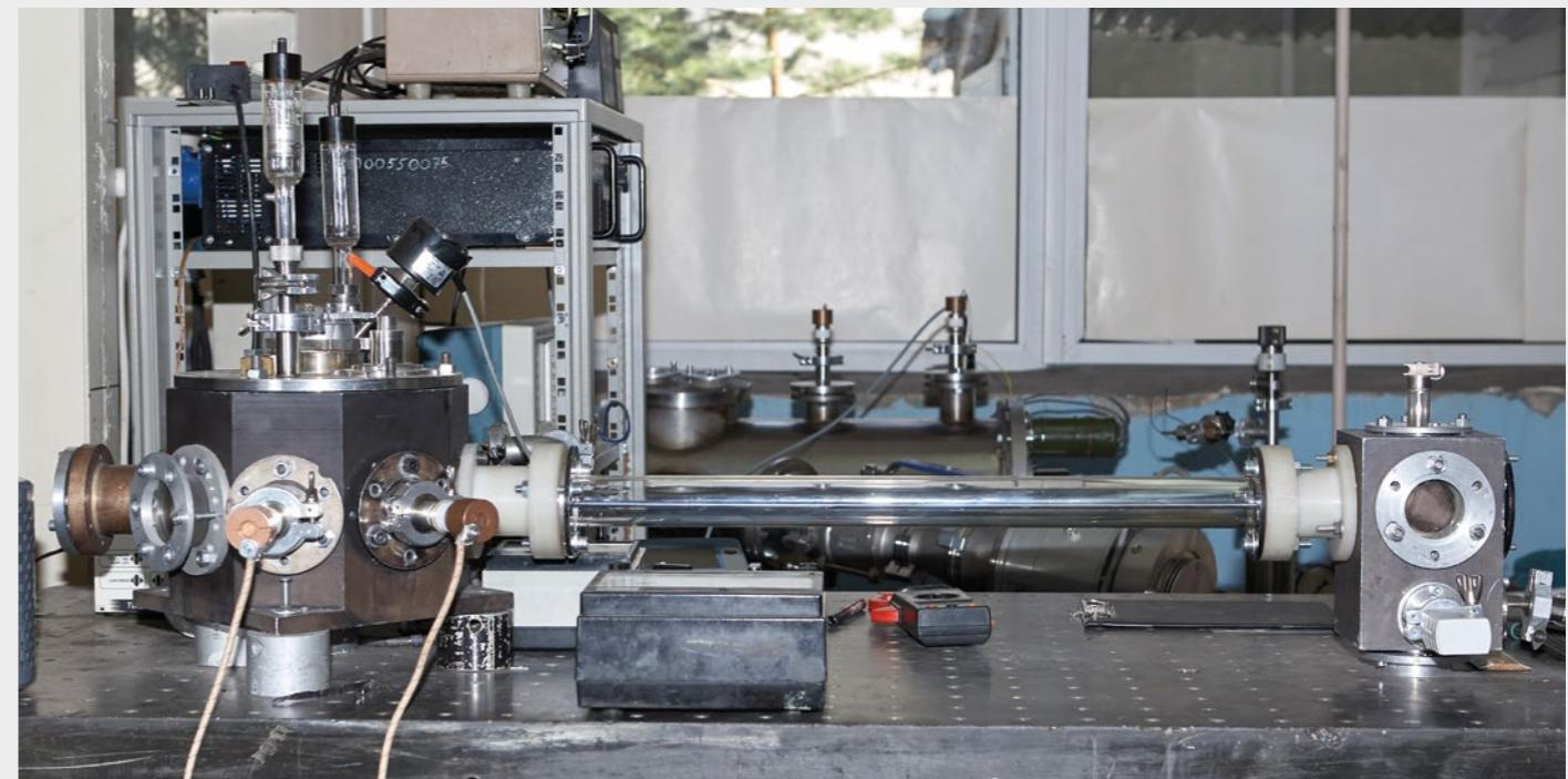
Установка для нанесения покрытий металлов на протяженные цилиндрические изделия методом магнетронного распыления катода коаксиальным протяженным разрядом с различными видами подготовки поверхности.
