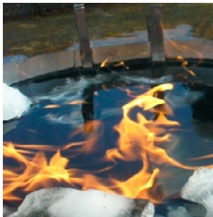
Лазерный поджиг и самоподдерживающееся горение на различных поверхностях: на льду, на воде под снегом, на открытой воде и на песке
