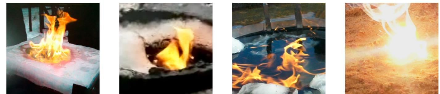
Лазерный поджиг и самоподдерживающееся горение на различных поверхностях: на льду, на воде под снегом, на открытой воде и на песке
